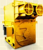
Con intercambiadores de calor Aire-Aire (IC611, IC616 e IC666)
