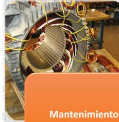
Mantenimiento correctivo de máquinas eléctricas rotativas y estáticas.
